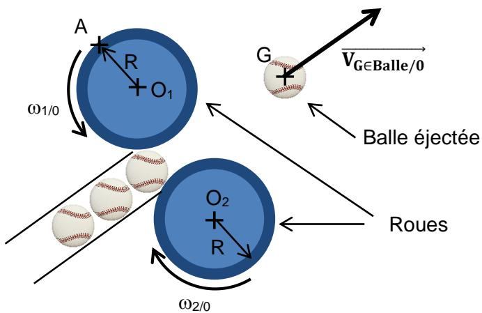
Les balles sont propulsées une à une en passant entre deux roues (1) et (2) tournant en sens inverse. L'adhérence entre les roues et les balles est assurée grâce à des pneumatiques.
