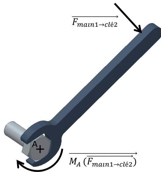
« **Torseur des actions mécaniques de 1 sur 2** »
