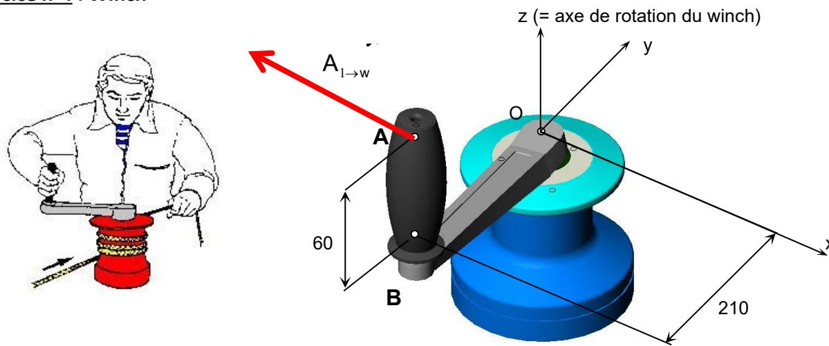
Un skipper (1) exerce sur la manivelle d'un winch force d'intensité **80 N** dont la droite support est parallèle à x et passe par le point A. On notera cette force  $A_{1 \rightarrow w}$ .
