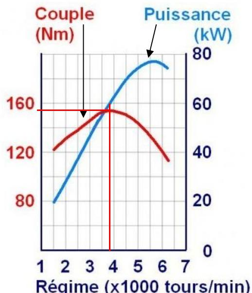
a)  $C_{\max} = 155 \text{ N.m}$  pour  $N = 3800 \text{ tr/min}$
