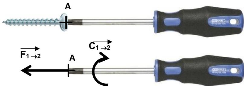
Modélisez l'action exercée par le tournevis (1) sur la vis (2) par un torseur.
