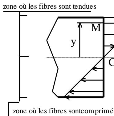
La contrainte normale  $\sigma$  en un point M d'une section droite (s) est proportionnelle à la distance  $y$  entre ce point et le plan moyen passant par G.
