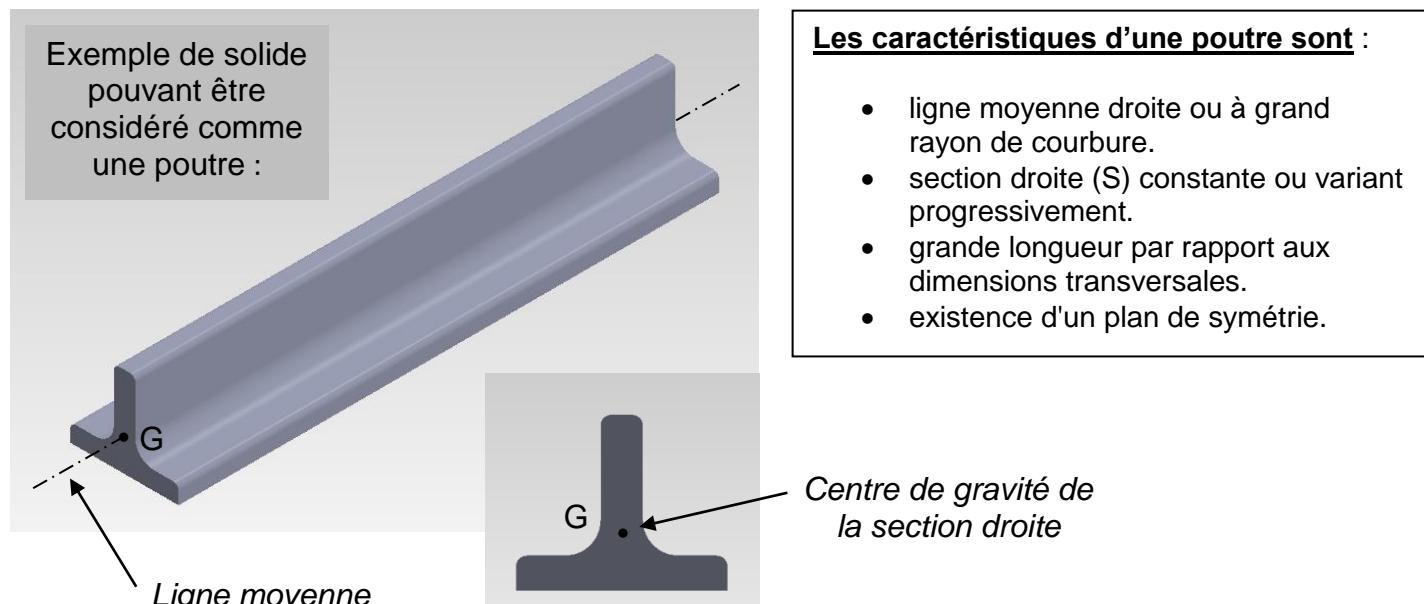
Les résultats issus de » la théorie des poutres » ne sont valables que si le solide étudié répond à la définition d'une poutre. Celle-ci précise que : « les dimensions de la section droite doivent être petites devant la longueur de la fibre moyenne »
