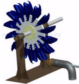
Turbine pelton (Rotation autour de l'axe x)
