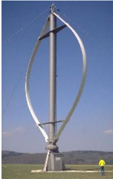
Eolienne à axe vertical (Rotation autour de l'axe y)
