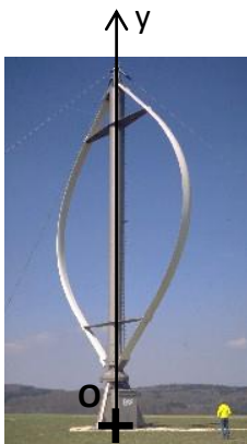
Eolienne à axe verticale (Rotation autour de l'axe (O,y))
