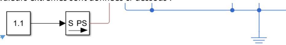
1,1V correspond à une impulsion de 550 microsecondes du signal PWM et à un angle de -90° du servomoteur
